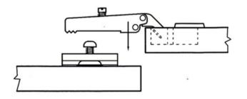
INSERT THE DOOR HINGES OVER THE PLAQUE ALREADY FIXED ON THE SIDE PANELS AND PARTITION
