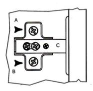
EXAMPLE 2 UNSCREW THE SCREWS (A+B) AND ADJUST THE DOORS IN THE RIGHT POSITION
